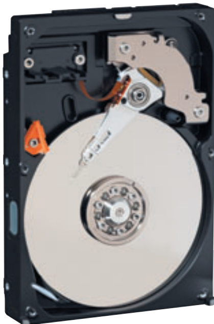
Внутреннее устройство обычного винчестера: корпус, шпиндель с пластинами и блок головок.
