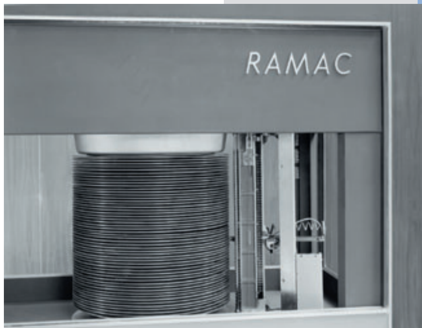
Дисковый узел накопителя RAMAC (фото IBM).
